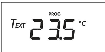
Taratura della temperatura esterna con step di 0.5°C.
