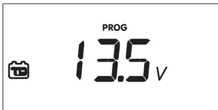
Taratura della tensione della batteria servizi "B2".
