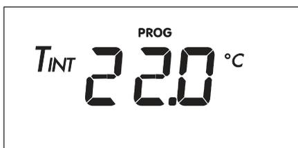
Taratura della temperatura interna con step di 0.5°C.
