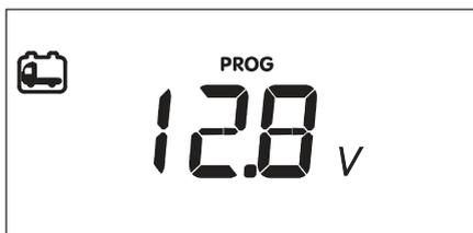
Taratura della tensione della batteria auto "B1".
